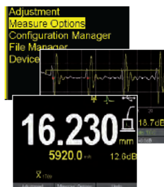
Пользовательский интерфейс дисплея: Структура меню, визуальное отображение А-скана с точками измерения и цифровая индикация показаний крупными символами, а также отображение дополнительной информацией для анализа результатов.
